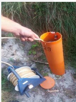
Pomiar głębokości występowania zwierciadła wód podziemnych
